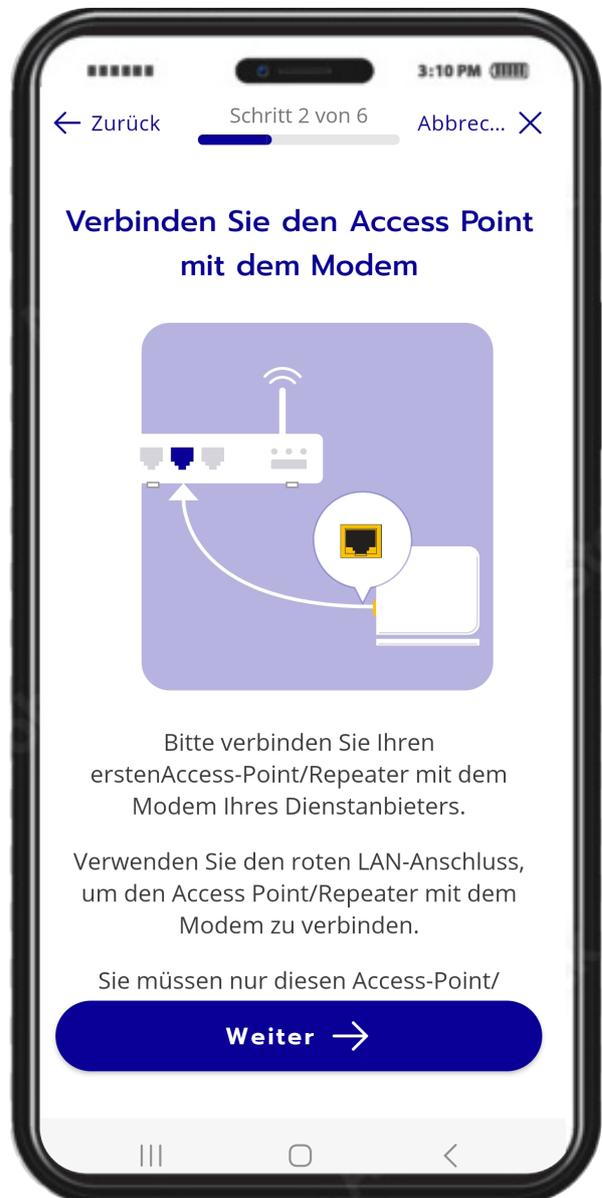
**Schritt 2 von 6:** Schließen Sie den Access Point mit dem beigefügten LAN-Kabel an die FRITZ!Box (Router) an.
